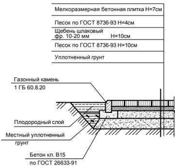
Конструкция покрытия площадки с островками для ТРК из бетонной мелкозернистой плитки
